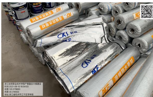
(底板防水材料送检)
