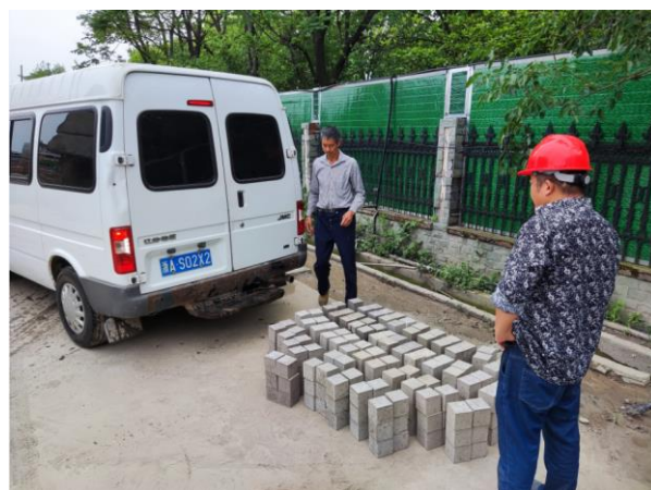
(混凝土试块送检)
