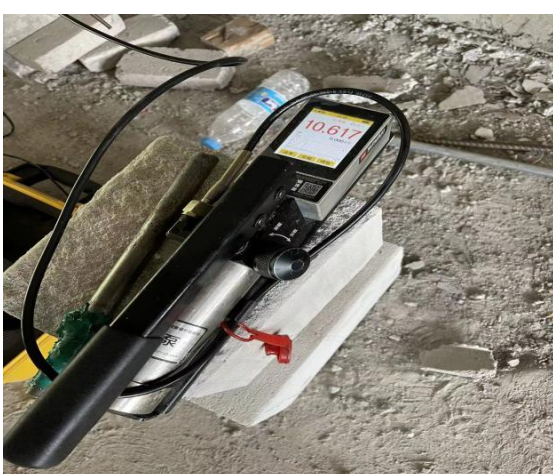
(钢筋拉拔试验)
