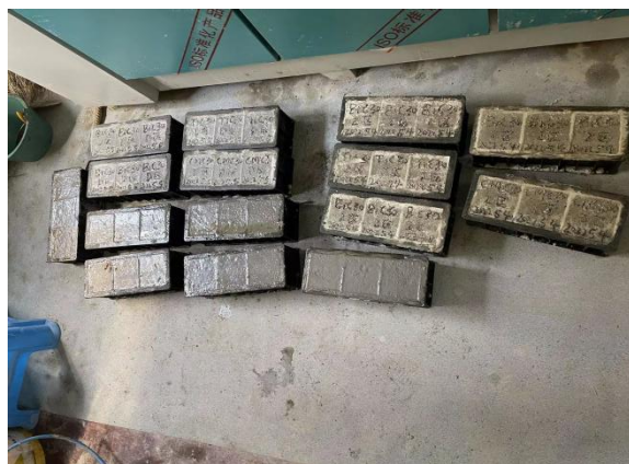
(混凝土试块留置)
